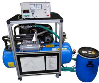
**F865 两级压缩机测试装置**
