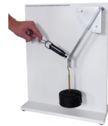
HFC38 Effort effectué par une force variable (verticale et tangentielle combinée)
