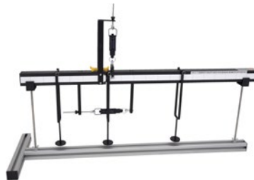
HFC31 Appareil d'étude de la combinaison de l'effort de cisaillement et du moment fléchissant
