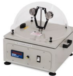
HTM71 Appareil d'étude d'un régulateur
