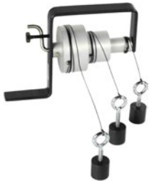
HTM22 Relation entre les vitesses angulaire et linéaire
