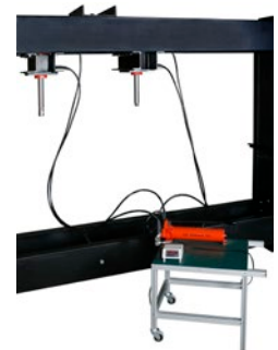
HPM3A Système de vérin hydraulique double
