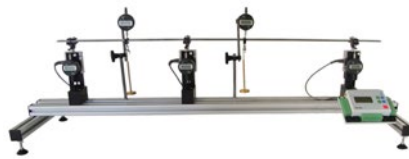
HSM1CD Appareil d'étude avancée des flexions de poutres, version numérique (6 poutres avec différentes épaisseurs fournies) Extras en option : HSM1f, HSM1g
