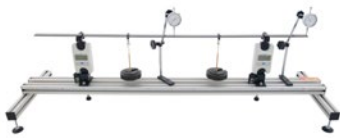
HSM1 Appareil d'étude de déflexion de poutres
