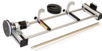
HSM2 Appareil d'étude de la torsion de barres
