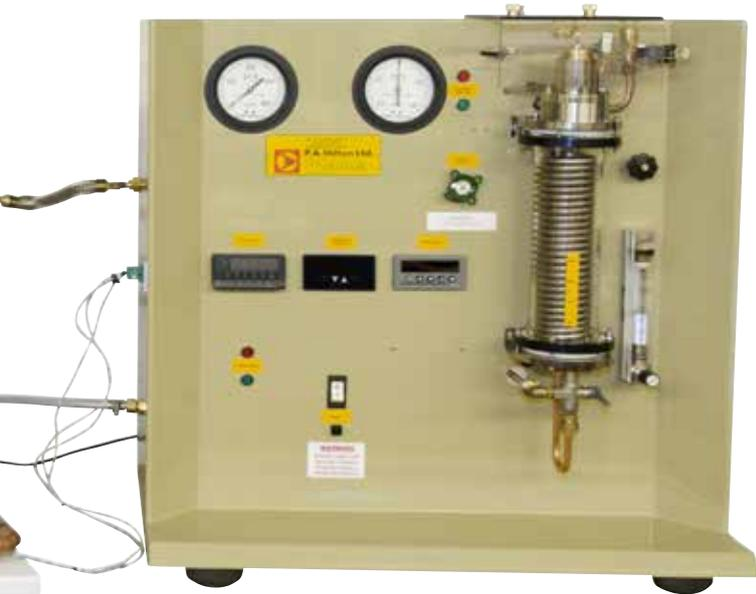
Il s'agit d'une unité à boucle fermée fournie en deux modules complémentaires contenant le générateur de vapeur électrique certifié, la pompe, la turbine à impulsion et le condensateur. L'unité permet aux étudiants d'identifier et de comparer les rendements maximum théoriques avec les résultats globaux réels.
