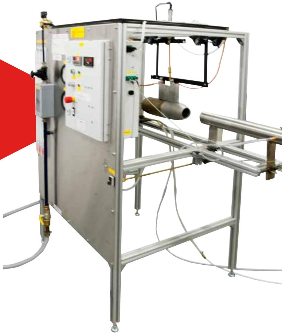
L'unité est fournie avec deux moteurs facilement interchangeables, permettant aux étudiants de comparer différents moteurs thermiques utilisant différents types de carburants gazeux. L'unité pleinement instrumentée permet le collationnement des vitesses d'échappement, températures, poussée, traînée et consommation de carburant.
